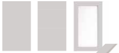
82 Basic Grå 16 mm sponplate med slagfast melaminbelegg. Solid 0,8 mm avrundet ABS-kant. Frosted glass i vitrine.
